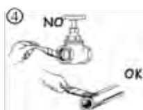
4 Använd gängtätning endast på rörgångarna, ej på skjutventilens gängor.
