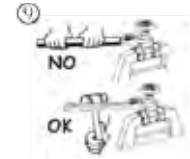
9 När överstycket monteras på skjutventilens hus är det viktigt att spanna försiktigt för att undgå att packningen mellan dessa 2 delar blir ödelagd.
