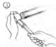
3 Avlägsna metallspån från rörändarna efter gängning. Metallspån kan förhindra tät anslutning.
