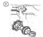
8 Avlägsna överstycket vid trånga arbetsutrymmen för enklare installation.
