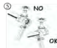
5 Vid montering använd fast- eller skiftnyckel, ej rörtång. Använd endast nödvändigt vridmoment och enbart på röränden av skjutventilen. Detta ger ett fastare grepp och undviker potentiell skada på skjutventilens hus.
