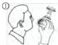
1 Inspektera skjutventilens gängor på smuts innan montering. Smuts kan skada ventilens tätning och förorsaka läckage. Avlägsna smuts vid förekomst.
